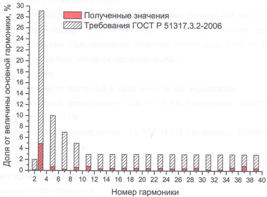
Рисунок 3 – Распределение тока по гармоническим составляющим образца при напряжении питания 220В
