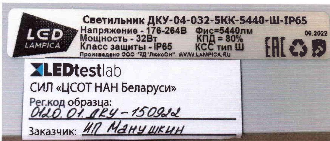
Рисунок 5 – Фотографии маркировки и регистрационной этикетки образца светильник светодиодный ДКУ-04-032-5КК-5440-Ш-IP65
